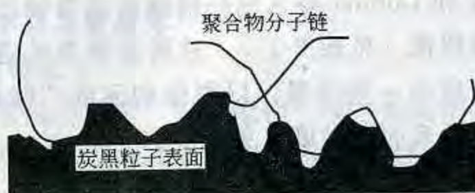
图 2-13 聚合物分子链吸附在炭黑粒子表面的模型
