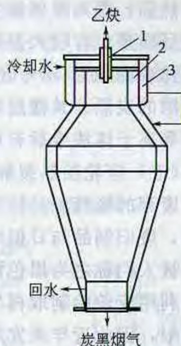
图 2-6 乙炔法炭黑反应炉结构
