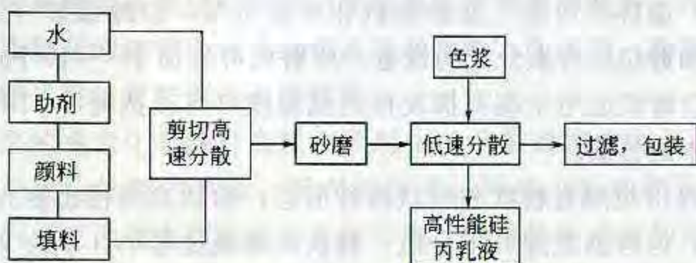
图 6-5 颜料分散及涂料制造过程示意
