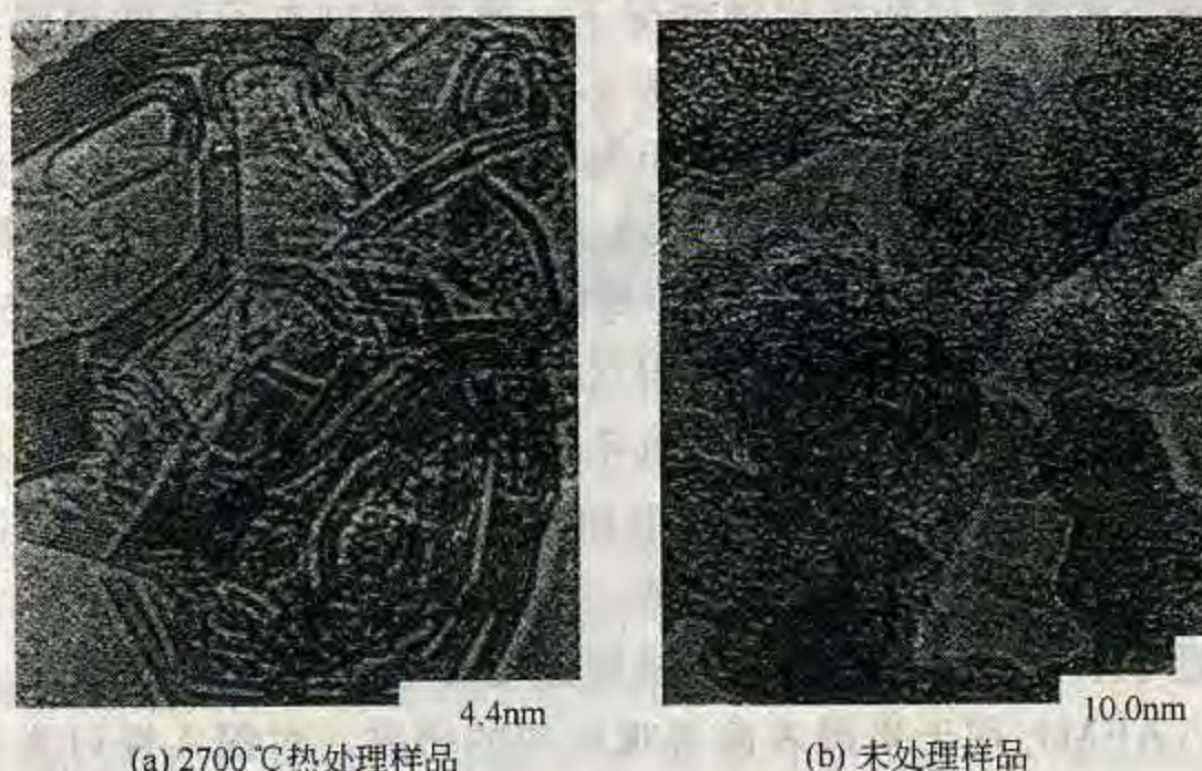
图 2-10 一种 N220 炭黑的高分辨率相衬电子显微镜照片
