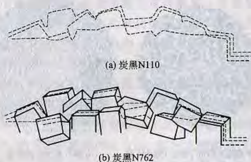
图 2-12 炭黑 N110 和 N762 粒子的表面微晶体模型
