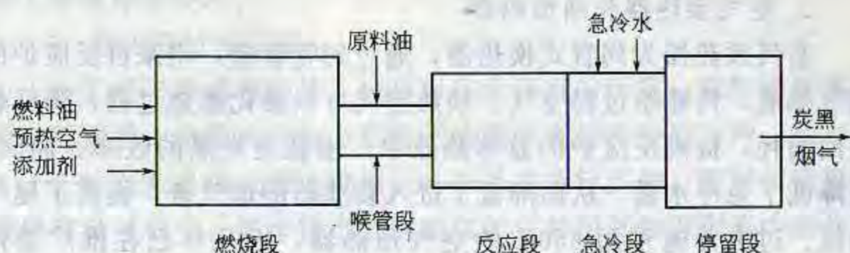
图 2-8 新工艺炭黑反应炉分段示意
