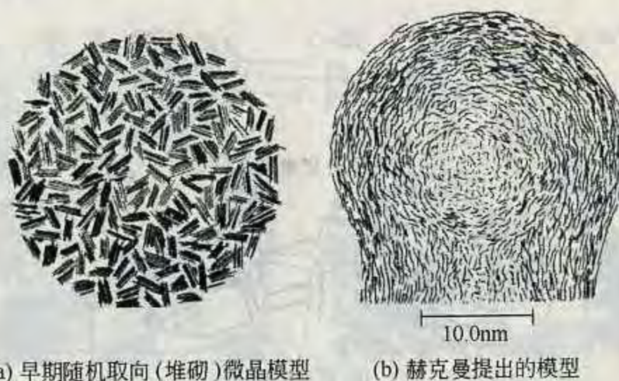
图 2-11 同心取向微观结构模型
